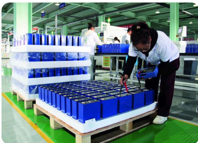
Recepción y control de celdas LFP.
